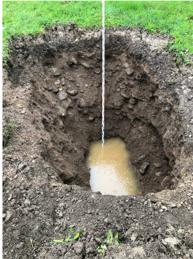
Abbildung 4: Grundwasser in Baggerschurf S10
